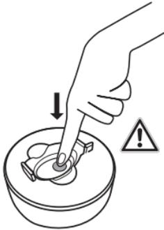
Yalıtımlı kaptan basınç oluşmuşsa, basınç dengeleme valfine basarak basıncı dikkatlice tahliye edebilirsiniz.
