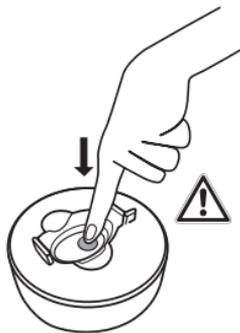
Sollte sich im Isoliergefäß Druck aufgebaut haben, können Sie diesen durch Drücken des Druckausgleichsventils vorsichtig entweichen lassen.
