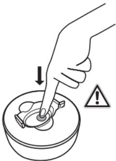
Если в изолирующей емкости образовалось давление, его можно осторожно сбросить при помощи уравнивающего клапана.
