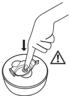
真空フードジャー内の圧力が高まってしまった場合は、圧力補償弁を押して圧力を慎重に逃がすことができます。
