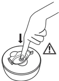
Si en el interior del recipiente se formara presión, puede extraerla con cuidado presionando la válvula de compensación de presión.
