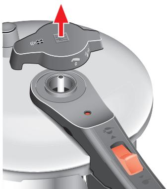
Fig. 21: Soulever le régulateur de pression
