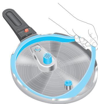
Fig. 6: Aftagning af tætningsringen
