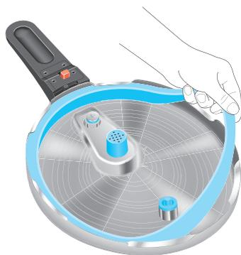
Рис. 6: Удаление уплотнительного кольца
