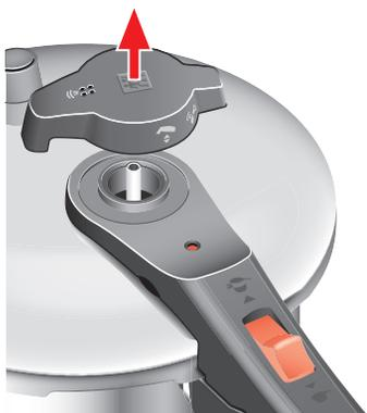
Рис. 21: Снять регулятор давления
