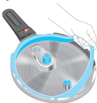
Fig. 6: Enlever le joint d'étanchéité
