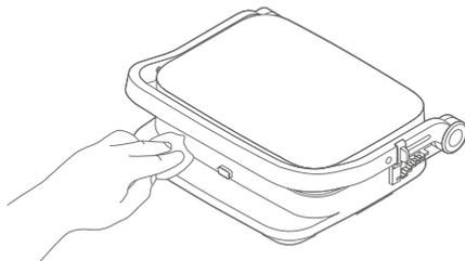
Na desni strani pritisnite napravo za odklepanje BBQ in popolnoma odprite aparat. Pritisnite odklepanje aparata za žar plošči, odstranite žar plošči in pladenj za otekanje maščobe ter jih pod tekočo vodo očistite z detergentom za pomivanje posode. Žar plošči skrbno posušite in se prepričajte, da ste očistili vse ostanke čistila.
