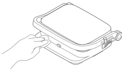
Πατήστε τη συσκευή ξεκλειδώματος BBQ στη δεξιά πλευρά και ανοίξτε τη συσκευή εντελώς. Πιέστε τη συσκευή ξεκλειδώματος για τις πλάκες ψησίματος, αφαιρέστε τις πλάκες ψησίματος και τον δίσκο στάγδην λιπών και καθαρίστε με απορρυπαντικό πιάτων κάτω από τρεχούμενο νερό. Στεγνώστε προσεκτικά τις πλάκες ψησίματος και βεβαιωθείτε ότι έχουν αφαιρεθεί όλα τα υπολείμματα από τα καθαριστικά.
