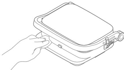
Trykk på BBQ opplåsingsenheten på høyre side og åpne apparatet helt. Trykk på opplåsingsapparatet for grillplatene, fjern grillplatene og dryppskålen, og rengjør med oppvaskmiddel under rennende vann. Tørk grillplatene grundig og forsikre deg om at alle rester av rengjøringsmidler er fjernet.
