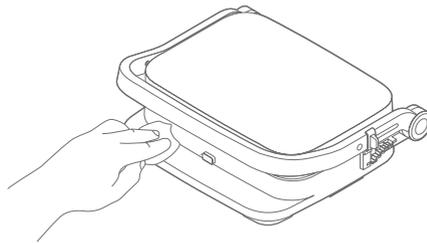
Appuyez sur le dispositif de déverrouillage du barbecue situé sur le côté droit et ouvrez complètement l'appareil. Appuyez sur le dispositif de déverrouillage des plaques du grill, retirez les plaques du grill et le bac de récupération des graisses et nettoyez-les avec du liquide vaisselle sous l'eau courante. Séchez soigneusement les plaques du grill et assurez-vous que tous les résidus de produits de nettoyage ont été éliminés.
